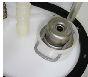
3 No módulo de combustível, junto à bomba de combustível (sistema multiponto returnless).
