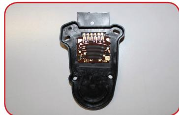
**4** – Ponga la tarjeta DS siguiendo la orientación de los contactos, agarrando siempre por los bordes. Evite al máximo el contacto de los dedos con las pistas y con los conductores.
