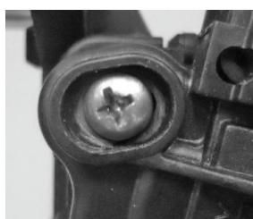
Posicione a tampa do pedal no centro do oblongo, ainda com o multímetro na escala VDC (tensão contínua) e a ignição ligada verifique o sinal do sensor para perfeito funcionamento, conforme abaixo:
