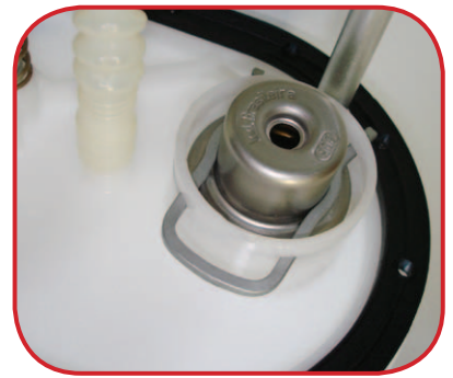
En el módulo de combustible, junto a la bomba de combustible (sistema multipunto returnless).
