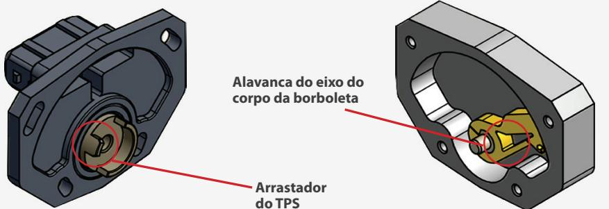
**5º passo:** Encaixe os parafusos no centro do rasgo de regulagem e apenas encoste deixando o TPS livre para posterior ajuste.
