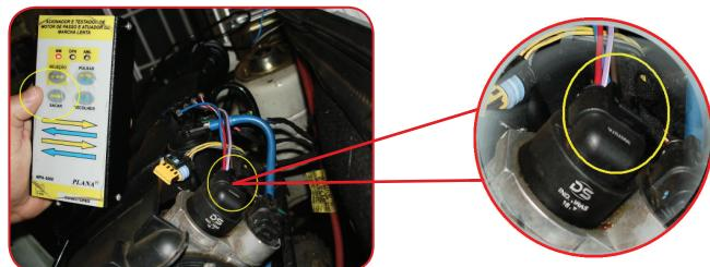
**1- Com o motor em funcionamento, retire o chicote do atuador e instale o aparelho de teste;**
